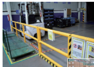
作業場と作業者の分離
