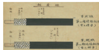
絶縁被覆部に糸を巻いていた 当時の主力製品「東京線」
